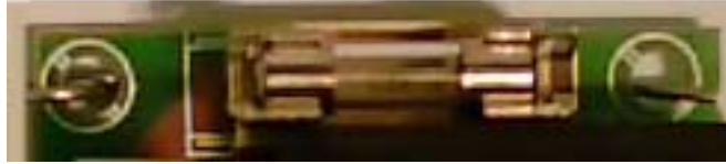
Fusible entre 2 y 4 amperios.
